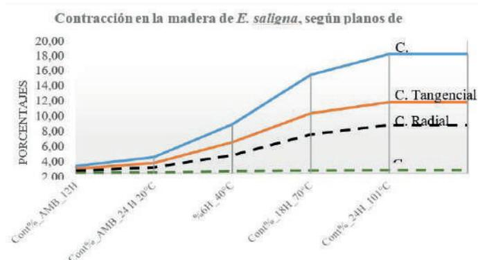
Fig. 2. Representación de la contracción de la madera de *E. saligna* según planos de corte
